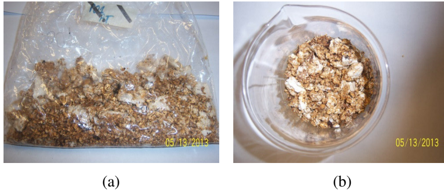
Figura 10 - Amostra do farelo de amêndoa com o fungo já incorporado, após 24 dias de incubação (a) e o mesmo após secagem em estufa (b).
